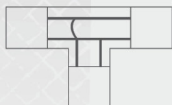
2490097 Conector T para tira led COB 8 mm 220V Conector T para fita de led COB 8 mm 220V
